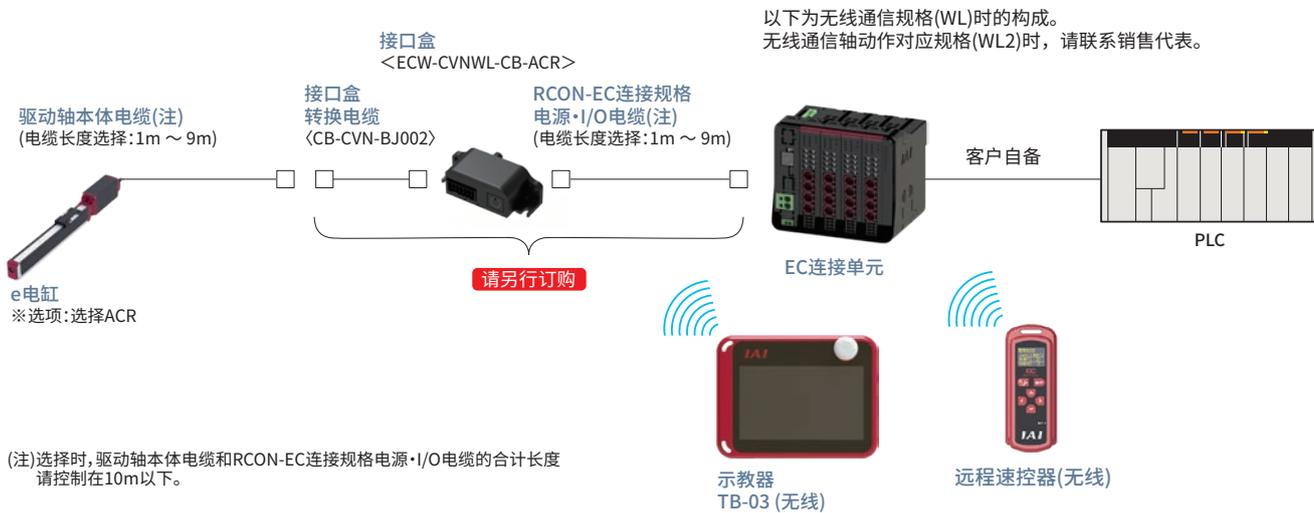
(注)选择时，驱动轴本体电缆和RCON-EC连接规格电源·I/O电缆的合计长度请控制在10m以下。
