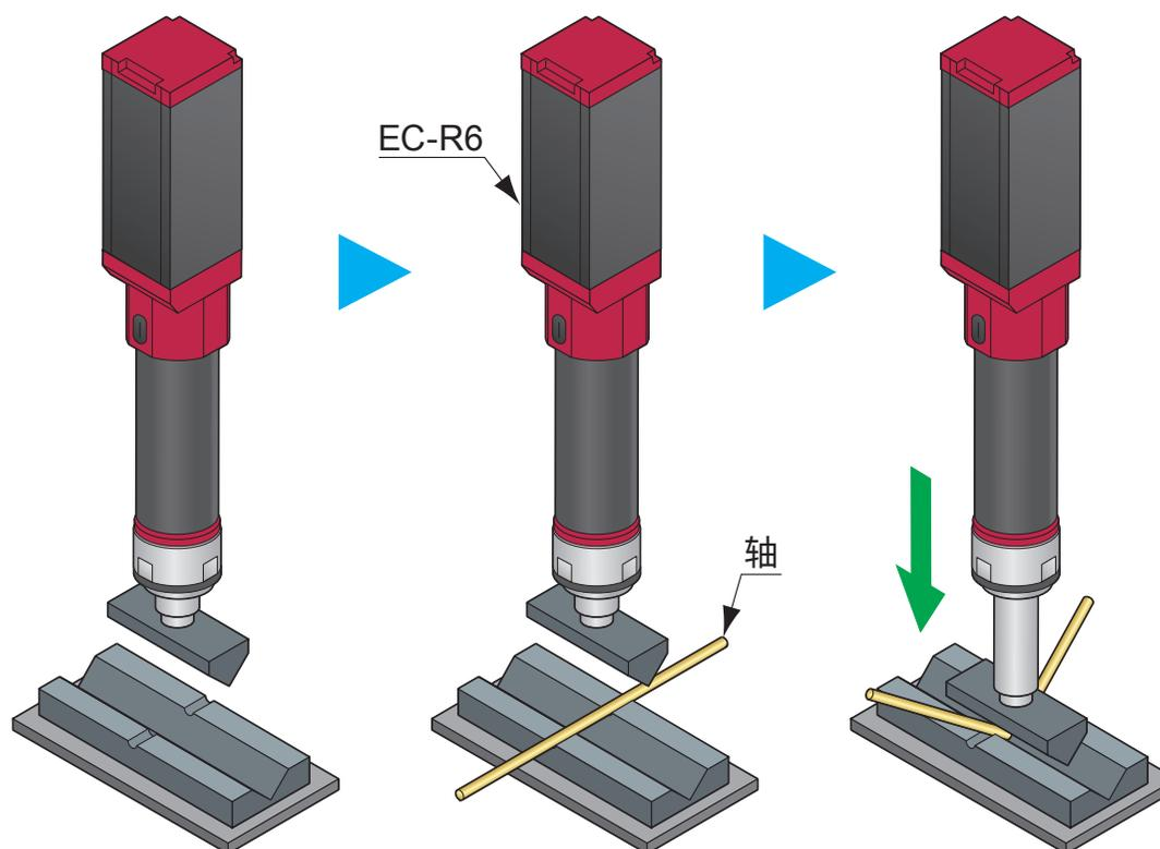
**说明** 以前，弯曲加工是利用气缸进行的，后来改为 e 电缸，实现了低速动作和按压稳定化，不再产生翘曲和飞边，并稳定了品质。
