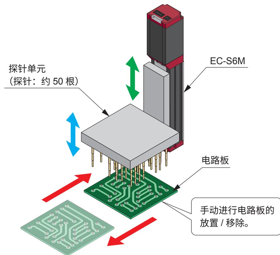
**说明** 以前使用的是气缸，但难以缩短紧急停止时的安全电路设计工时(残压对应、恢复时的防飞出等)，且紧急停止后的恢复步骤比较复杂。
