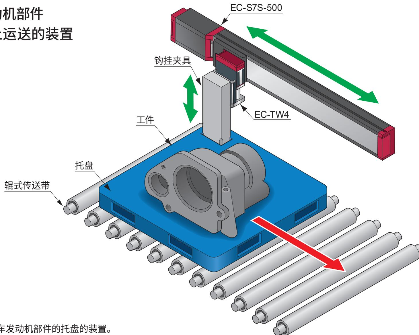
**说明** 用于推出装有汽车发动机部件的托盘的装置。
