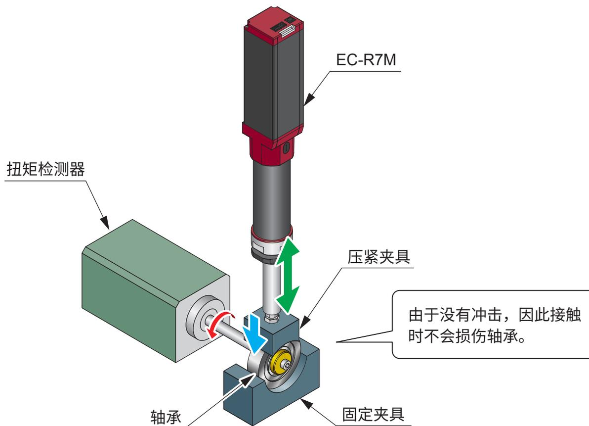
**说明** 使用气缸时，速度、加减速速度不稳定，发生了因压紧夹具的冲击而导致轴承损伤的不良现象。
