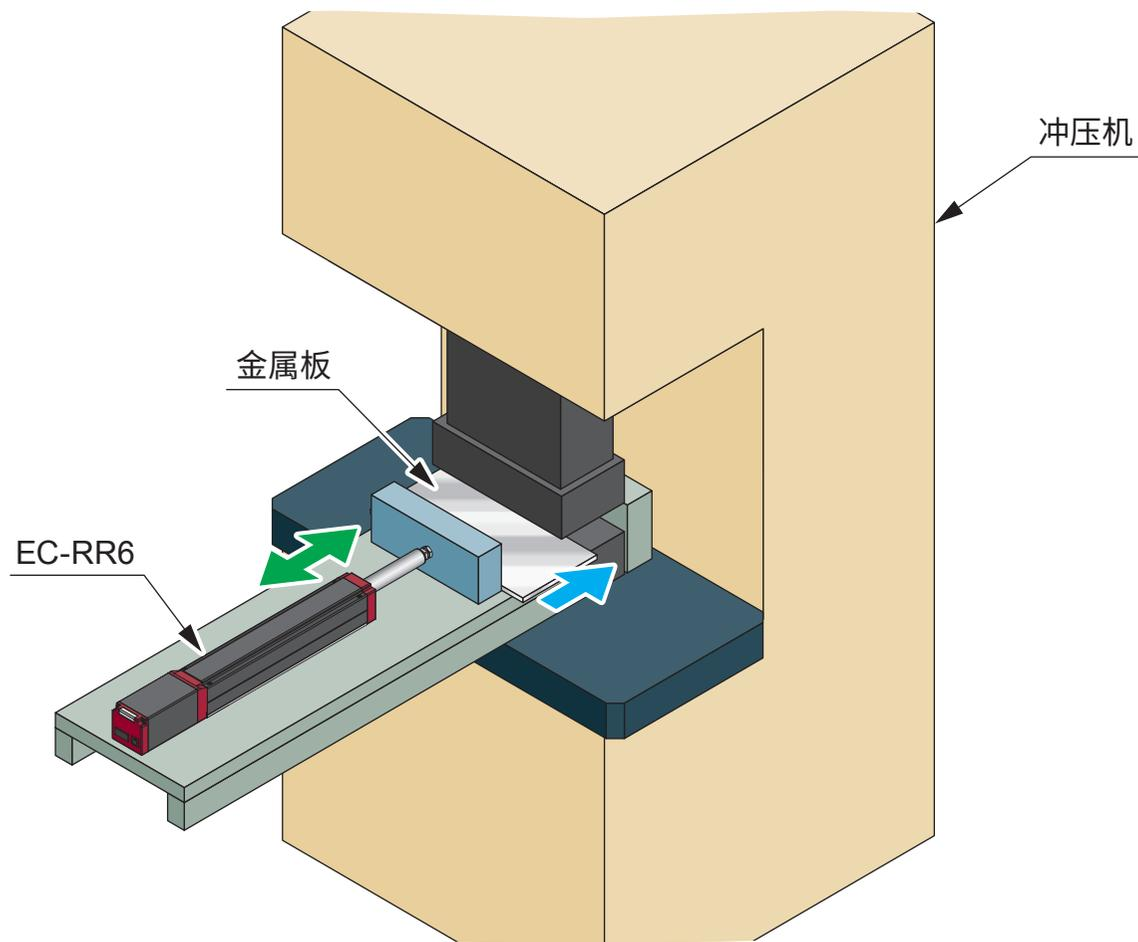
**说明** 以往，为了在冲压机上放置金属板并推至底部，作业人员需要把手伸入冲压机内。使用 e 电缸将推至底部的工序电动化，大大提高了操作性。
