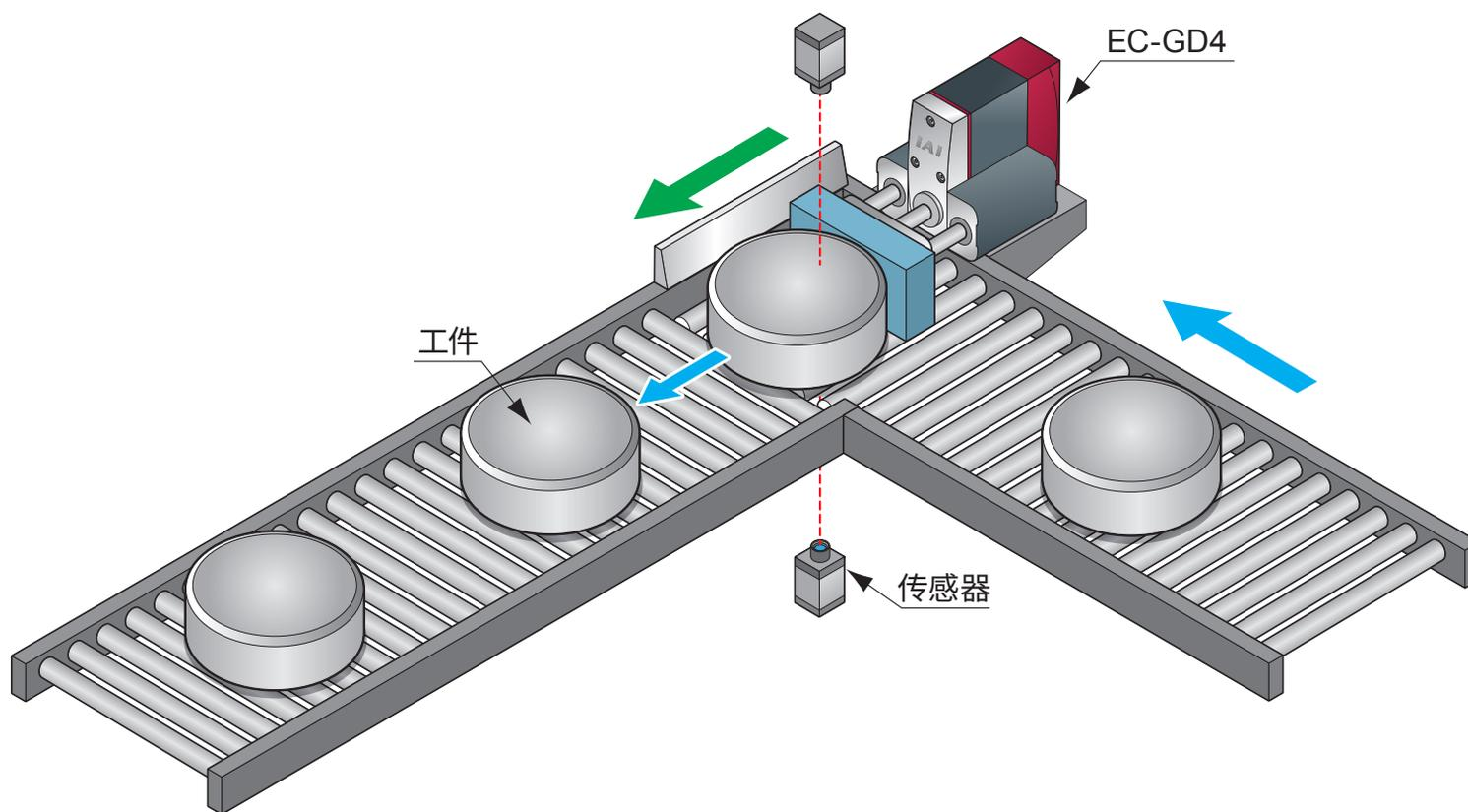
**说明** 因为没有空气源，此前都是人工进行转移，通过使用 e 电缸，实现了自动化。由于可以设定加速度，因此与气缸相比可以有效防止工件损伤。
