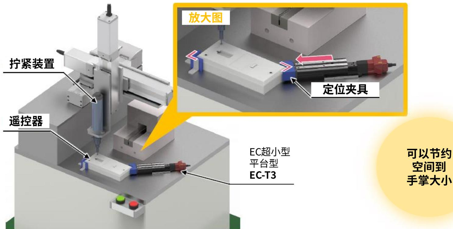
**解说** 为了上紧螺丝，需要对准被粗略放置的遥控器，而用来将遥控器推送到位的，正是EC系列超小型平台电缸EC-T3。
