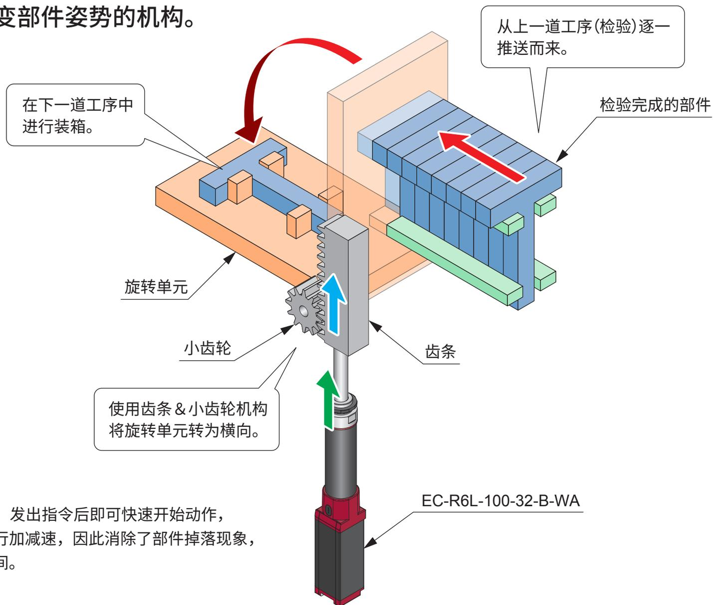
**说明** 使用 e 电缸时，发出指令后即可快速开始动作，并能平稳地进行加减速，因此消除了部件掉落现象，缩短了动作时间。
