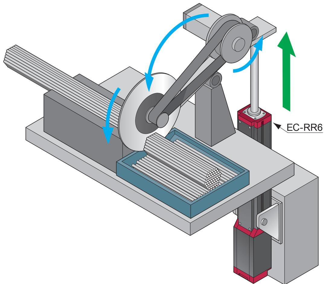
**说明** 采用 e 电缸，可以精确设定切断速度，实现稳定的动作。
