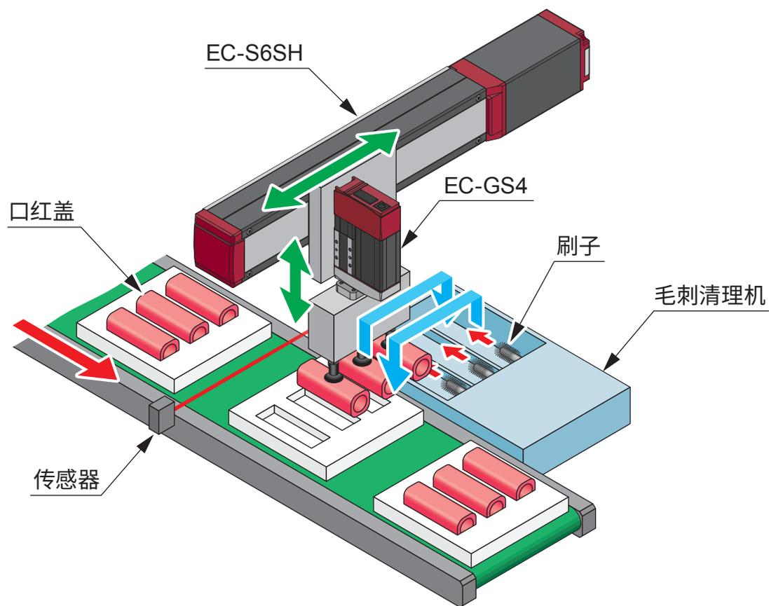
**解说** 通过采用 e 电缸可以以数值单独调整 A: 加速度、V: 速度、D: 减速度。这样进行缓慢加 / 减速设定。
