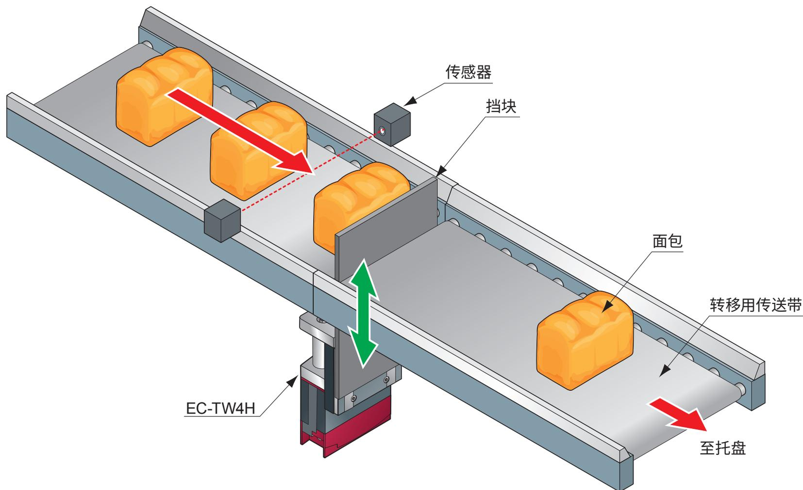
**说明** 将面包移至托盘上时，会向转移用传送带排出，但需要用挡块改变运送时间。由于使用 e 电缸能很容易地进行起点、终点的位置调整和速度、加减速度调整，因此可顺畅地变更运送时间，并缩短了周期时间。
