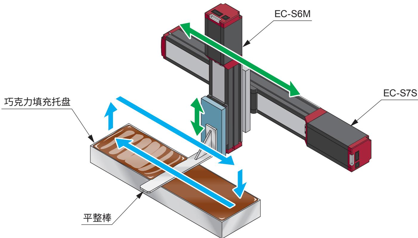
**说明** 在平整巧克力时，如果使用气缸，停止时的振动会传至平整棒，导致巧克力表面产生波动，难以平整。使用 e 电缸后，可以调整加减速度，消除了表面波动并缩短了调整时间。
