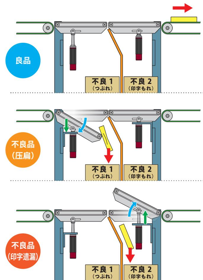
**说明** 以往使用气缸上下移动分拣门。有时会因停止时的冲击把合格产品弹出传送带。而使用 e 电缸可以调节加、减速度，不会弹出合格产品。
