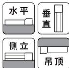
※垂直·侧立·吊顶姿势安装时,根据机型不同,有不同的使用限制。详细内容请参考1-345页。
