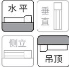
※吊顶姿势安装使用时,根据机种不同,有不同的使用限制。
